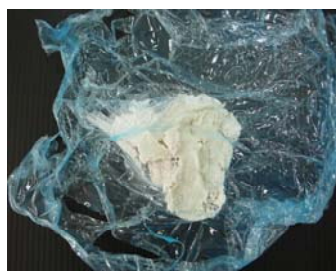
▲ 力道控制不當造成薄膜破掉
