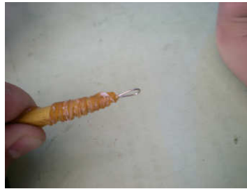
5.以快乾接著，並用橡皮筋固定
