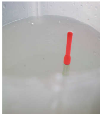
照片二、將浮標掛上鈞組，測量浮標的總浮力
