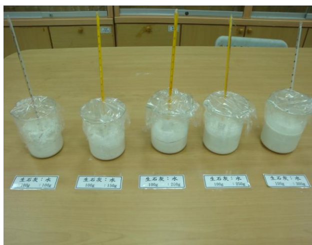
圖 4-2：計算不同比例所能到達的最高溫度
