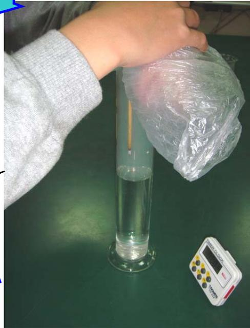
點燃 1 根線香放入上述量筒內，同時將量筒上方封上塑膠袋，封住的時間為 60 秒。
