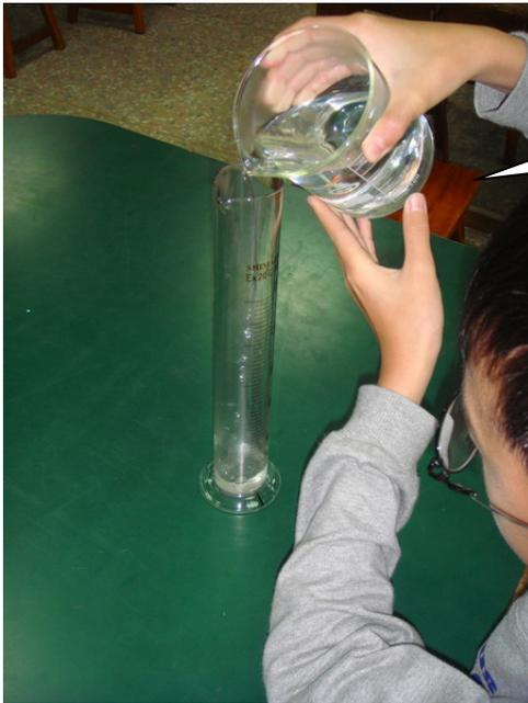
在 250 毫升的量筒內，倒入 150 毫升溫度約 45°C 的水。
