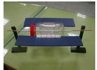
圖三十八：轉動可產生水波的起波器
