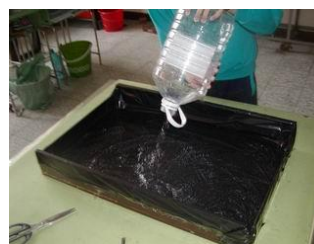
圖二十五：測試包垃圾袋抽屜的防水效果
