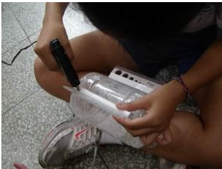
圖三十一：將尺黏在糖果罐來推動水波
