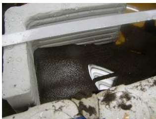
圖八十六：模擬海浪後，右 L 型漁港淤沙嚴重
