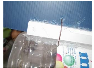
圖三十四：使用鐵絲纏繞讓扇葉更堅固
