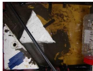
圖八十八：第 20 下海浪，兩側沙子都往外堆積
