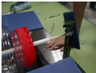
圖三十七：使用瓦楞板卡住棒子，避免移動
