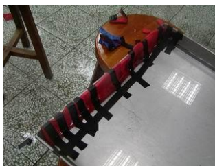
圖十二：加上海綿避免水波反彈
