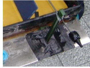
圖四十五：將鐵架黏在鋼板上，避免搖晃
