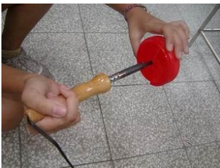
圖三十五：利用焊槍將糖果罐蓋子鑽洞
