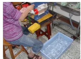
圖五十八：轉動扇葉會潑水，地板放容器接水
