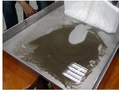
圖九十九：中水管的沙子被沖到遠處，出海口沙子堆積少
