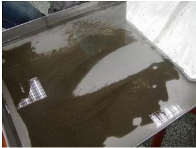
圖九十八：大水管水流流速太快，沙子被沖到另一側
