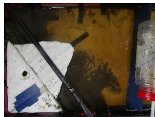
圖八十七：第 40 下海浪，沙子就堆積漁港右側
