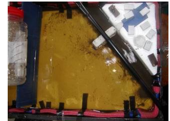
圖五十四：利用邊線可知道沙子移動情形
