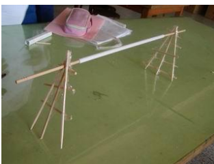
圖三十九：使用筷子設計出起波器的架子
