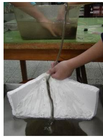
圖九十五：利用虹吸原理吸上面水族箱的沙子
