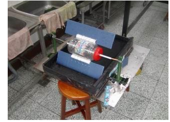
圖四十六：方便轉動而牢固的鐵絲架
