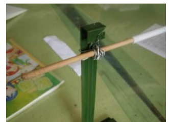
圖四十二：使用鐵絲做的環套住轉軸
