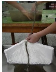
圖九：利用虹吸原理吸上面水族箱的沙水
