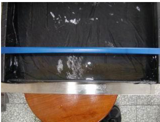
圖四十七：沙子擺放和起波器平行，沙子不會移動
