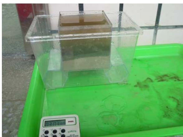
照片三十六 泥岩的透水性實驗，可以看到水慢慢滲下的過程，表層積水，表土已有部分滲水，底部的土仍是乾的
