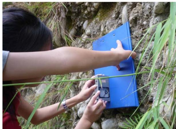
照片三 量坡度的方法：1. 緊貼岩壁(右上)； 2. 量出水平(下左)； 3. 量出坡度(下右)
