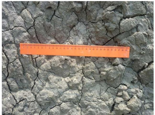
照片十八 泥岩膠結疏鬆，表面有許多裂痕
