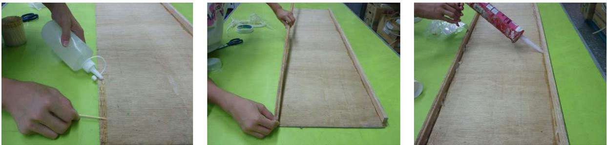
照片三十 河道製作過程：(由左至右) 1. 在木板兩側塗上保麗膠；2. 粘上木條；3. 塗上矽膠以防漏水
