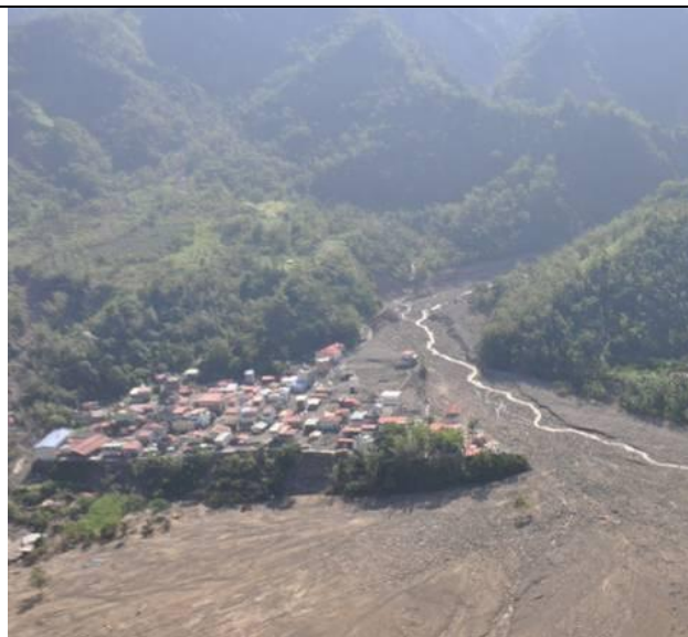
南沙魯村 位於低位河階地，南側發生土石流沖積扇。（資料來源：經濟部中央地質調查所）
