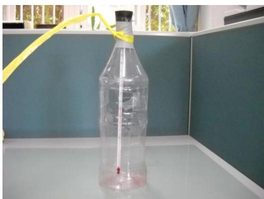
圖一：自製海水溫度計
