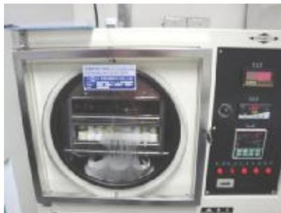
圖 2 冷凍乾燥機
