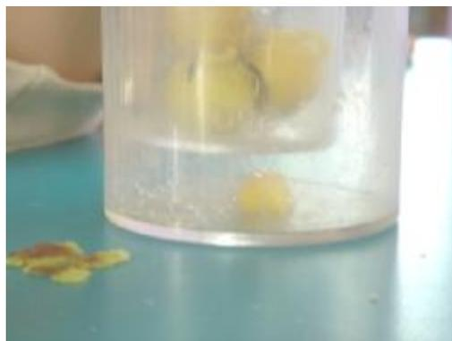
圖 17 利用杯子和砝碼測量脆度
