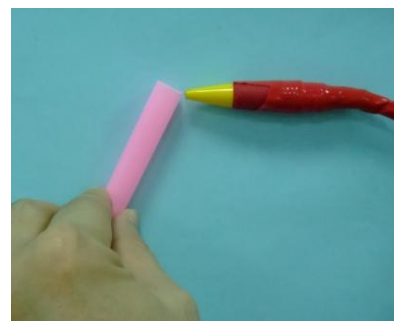
圖26 排笛需與吹氣口保持約0.2 ~ 0.5 cm左右距離
