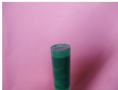
圖46 以保麗龍膠再外覆約1~2公分深度後的吸管
