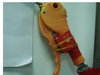
圖27 控制空氣鎗空氣流量方法(固定法)
