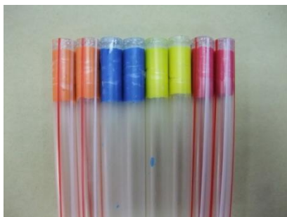
圖46 以保麗龍膠再外覆約1~2公分深度後的吸管
