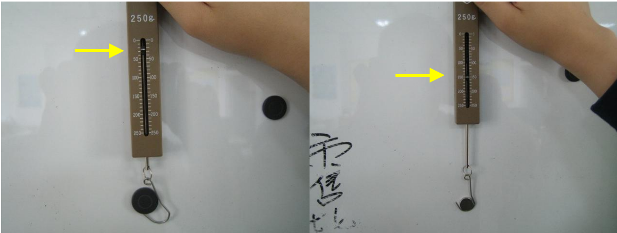
圖 6、不同磁鐵磁力大小的測試
