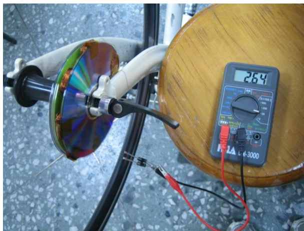
圖 15、轉動前輪可產出約 2.64v 的電壓
