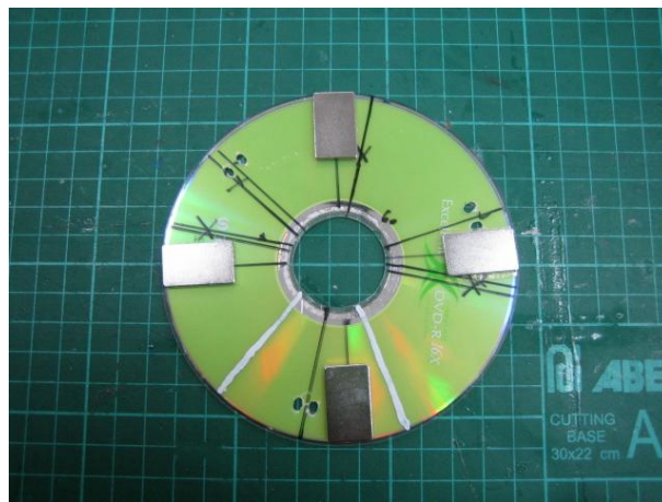
圖 12、4 個磁鐵固定於光碟上
