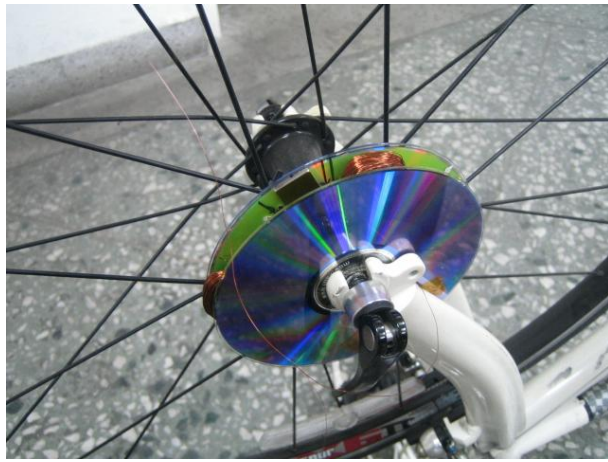
圖 13、光碟發電機固定輪及軸上
