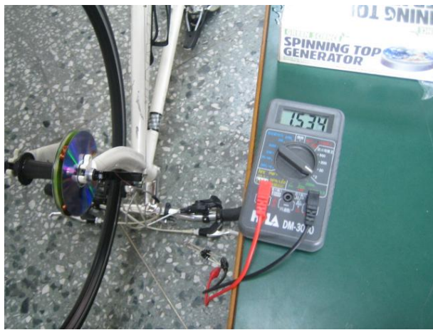
圖 14、轉動前輪可產出約 1.53v 的電壓
