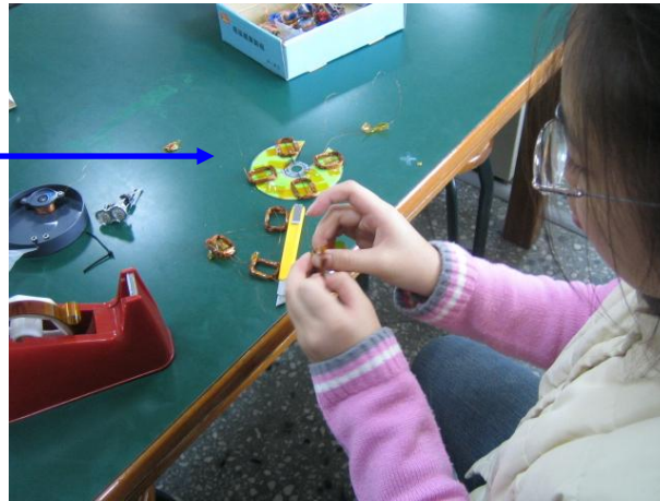
圖 11、4 個圈繞線的線圈固定於光碟
