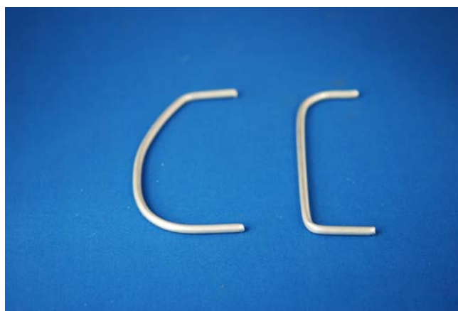
圖 4-12、將鋁管彎曲成直、彎兩種形式
