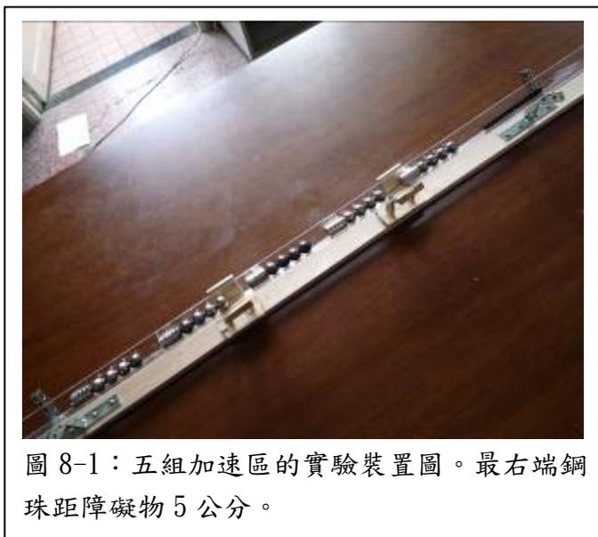
圖 8-1：五組加速區的實驗裝置圖。最右端鋼珠距障礙物 5 公分。
