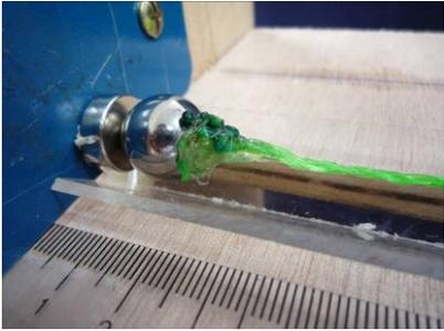
圖 3-11: V 型軌道前端的木板釘上鐵片，方便吸附磁鐵。
