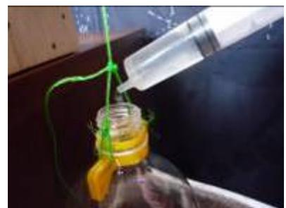
圖 3-16: 定滑輪下方懸掛塑膠桶，以針筒注水。
