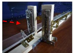
圖 8-7：報夾設計可以更換防撞材質。
