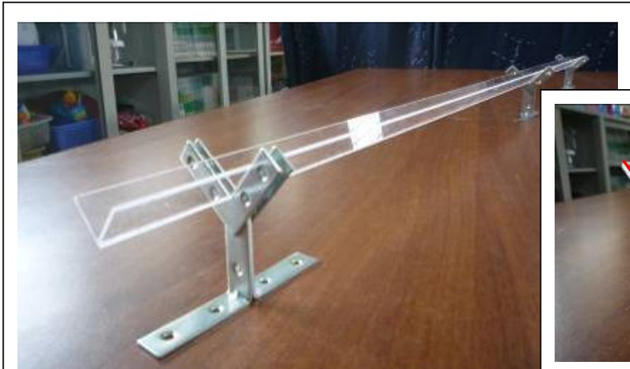
圖 3-1：壓克力製的 V 字型軌道。
