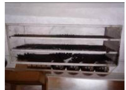
圖 9-5：立體磁力線測量儀在軌道各區觀察磁力線分布。
