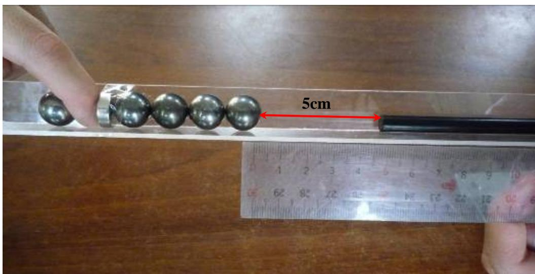
圖 3-3：磁鐵與鋼珠呈現左 1 右 4 的組合，在距離最右端鋼珠 a 的 5cm 處，放置一長管子當作障礙物。
