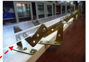
圖 8-6：軌道鐵製支架改為銅製支架，可避免磁力影響。
