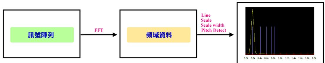
圖 12 訊號經過快速傅立葉轉換後繪製頻譜並顯示訊號可能頻率
