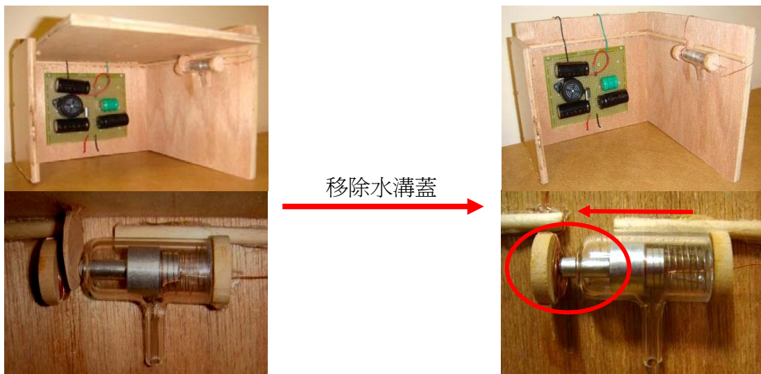
圖 6-12 水溝蓋防盜器之作動情形
