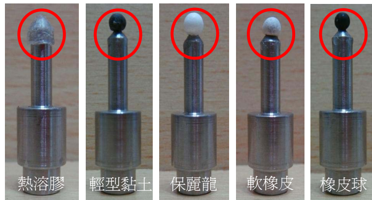
圖 5-11 不同氣密材質與浮子的配合
