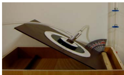
圖 4-3 配合皂泡流量計之使用情形
