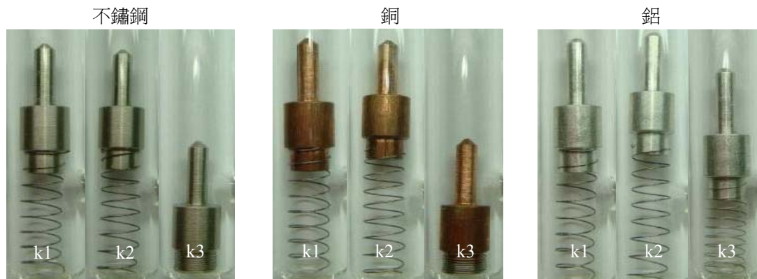
圖 6-1 不同材質浮子配合 k1、k2、k3 彈簧
