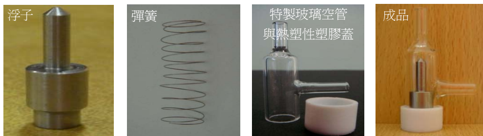
圖 4-1 溢流切斷裝置使用材料
