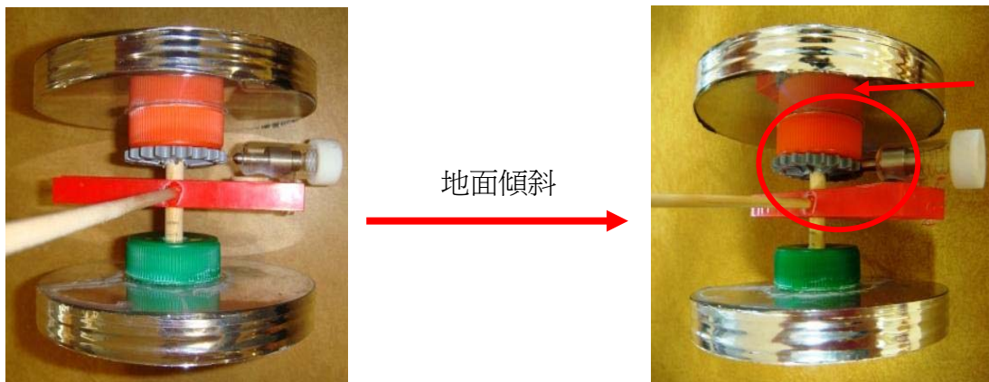
圖 6-11 娃娃車煞車器作動情形
