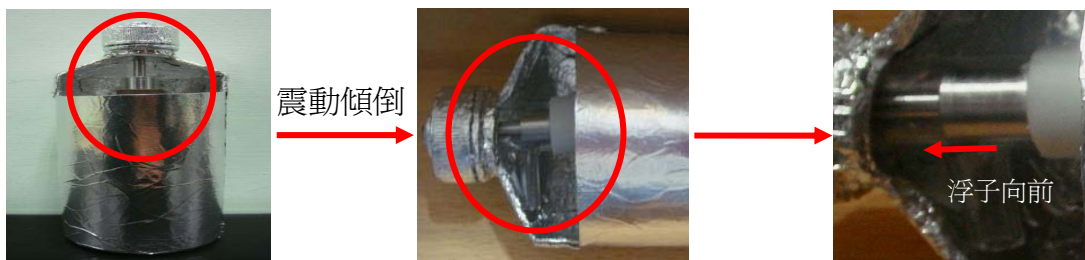
圖 6-7 瓦斯桶關閉裝置之作動情形
