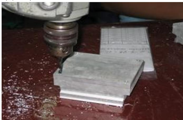
圖 51 散熱片鑽孔
