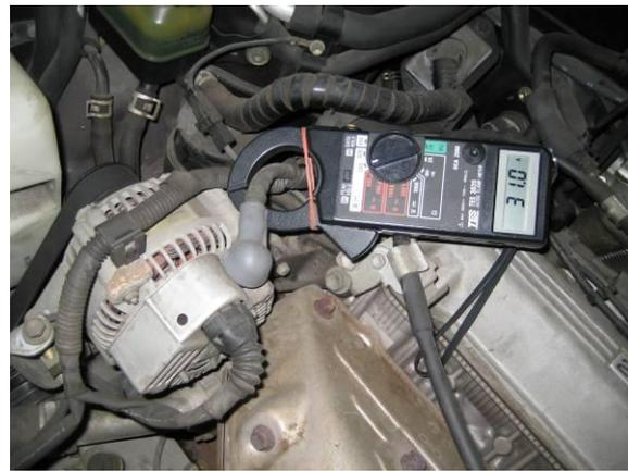
圖 38 改良冷氣測得電流
