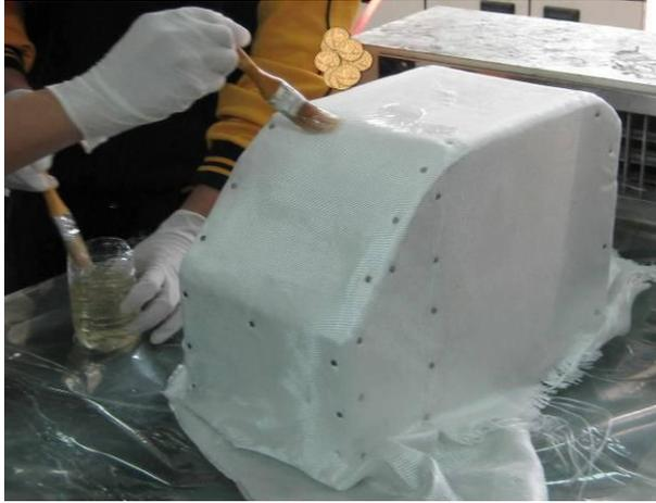
圖 22 用鐵釘固定壓出形狀
