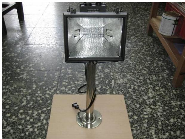
圖 60 製作模擬太陽光的鹵素燈架
