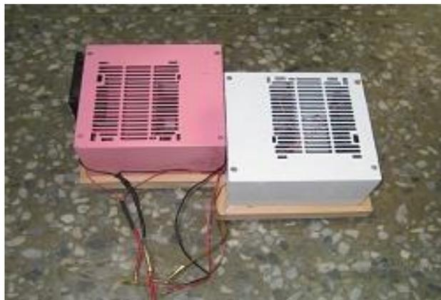
圖 56 加工散熱器與冷風器並製作木質底座
