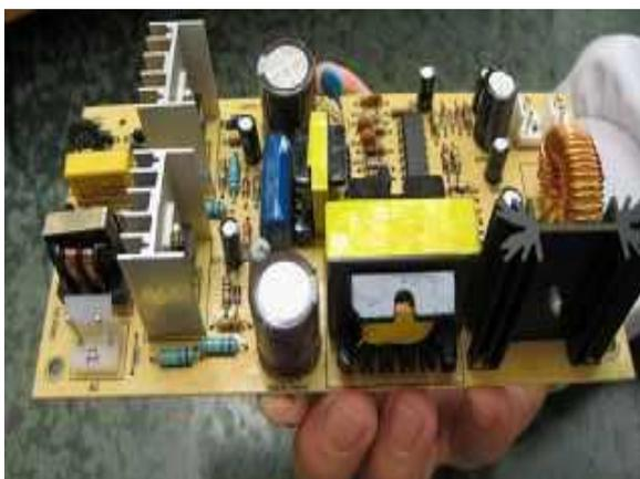
圖 13 致冷晶片控制電路板
