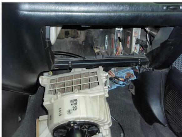
圖 3 鼓風機接線拆除
