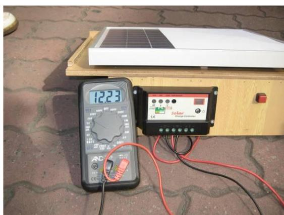
圖 17 測試陽光下太陽能板的發電電壓
