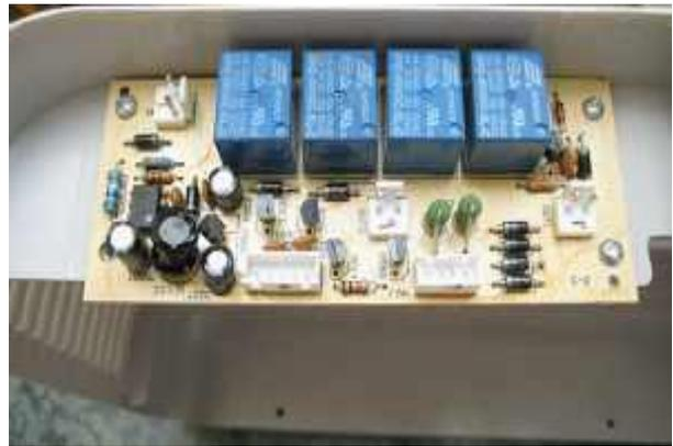
圖 12 溫度控制電路板
