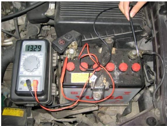
圖 37 改良冷氣測得電壓
