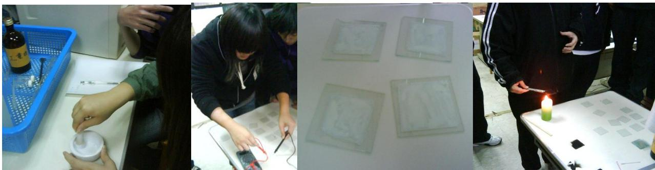
圖一 (A)奈米級二氧化鈦研磨；(B)導電玻璃測試；(C)二氧化鈦奈米層燒結。(D)對應電極碳膜燒結
