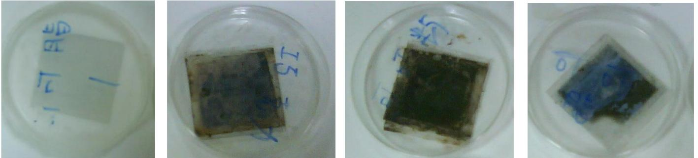
圖四 (A)可可脂染色中；(B)黑巧克力DSSC；(C)可可粉DSSC；(D)可可脂DSSC。
