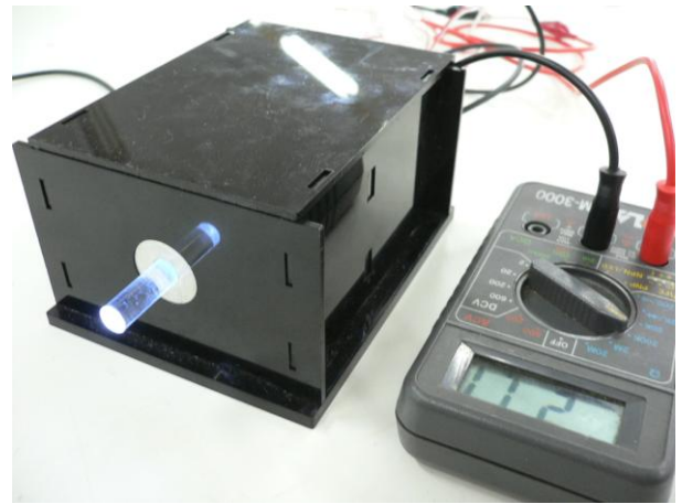
圖 13、光敏電阻實驗架構
