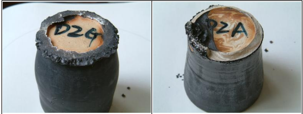
圖 20：溫度設定過高，釉藥流動嚴重，以致於黏附在棚板上。
