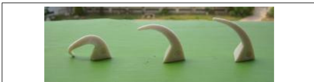
圖 13：8 號椎體倒伏情況，三者都處於同溫設定下，然第一個因為棚板合併，倒伏嚴重，測得溫度明顯遠超出其他兩者。
