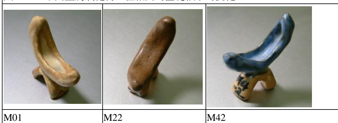
圖 14-1：不同金屬氧化物，在相同的基礎釉下的變化 01
