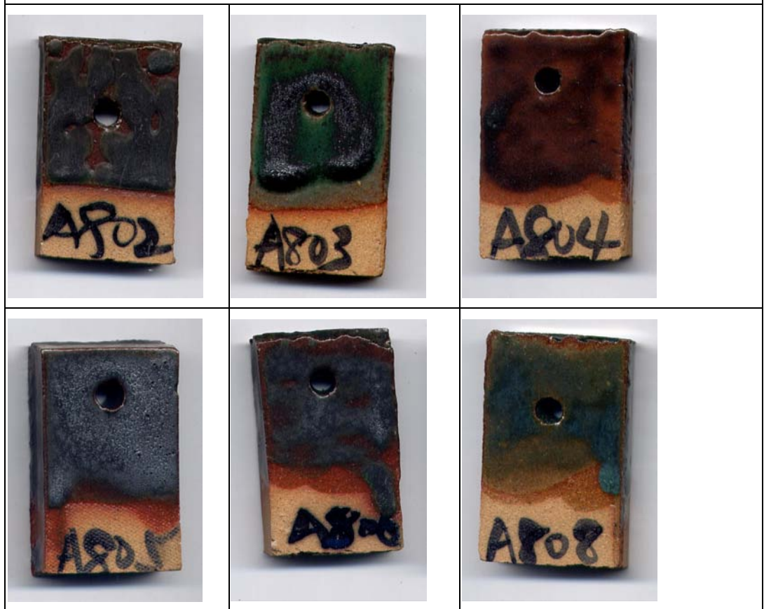
圖 15：相同金屬氧化物，在不同的基礎釉下顏色、質感的變化
