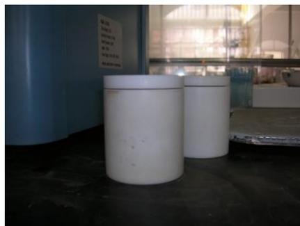
圖 4-9 鐵氟龍壓力鍋 (水熱合成裝置)
