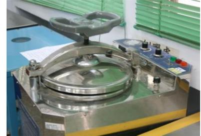
圖 4-3 高壓滅菌釜 HUXLEY
