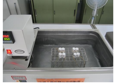
(A)配置 8 種草酸鈣飽和溶液，分裝於試管中 (B)於 35°C 恆溫水槽培養並定期取樣觀察
