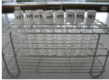
(A)配置 8 種草酸鈣飽和溶液，分裝於試管中 (B)於 35°C 恆溫水槽培養並定期取樣觀察
