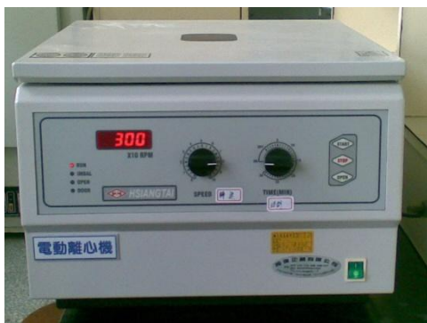
(D) 以 3000 rpm 離心五分鐘
