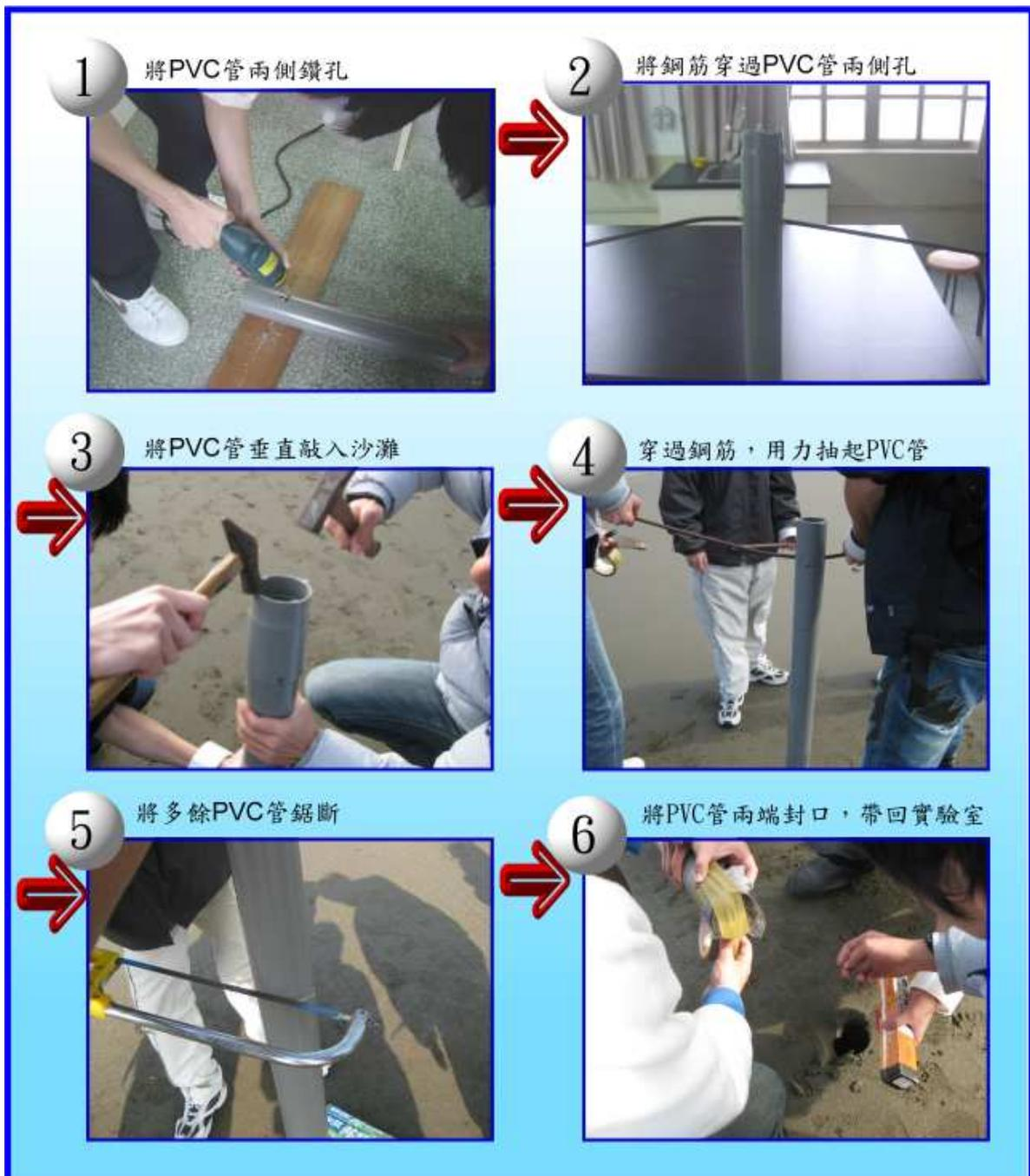
圖 4-7 步驟一：採管前準備工作及採管過程圖
