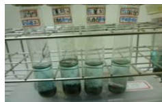
一天後離心後抽去上層溶液，再稀釋混和均勻、離心，重複三次以上。(去除不相干離子)
