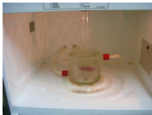
圖十四 微波爐內部裝置了攪拌機
