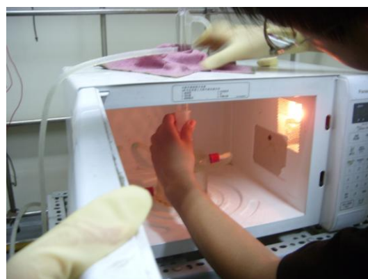
圖十六 放置裝有反應物的圓底瓶於微波爐中
