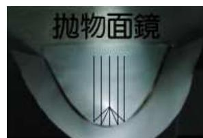
圖 7：LED 經拋物面鏡的圖形
