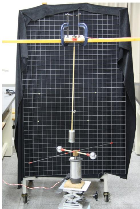
(三)改變不同的自轉轉速  $\omega_{\text{(自)}}$ ，紀錄公轉週期  $T_{\text{(順)}}$ 、 $T_{\text{(逆)}}$ 。比較觀察  $T_{\text{(順)}}$ 、 $T_{\text{(逆)}}$  與馬達不轉時錐動擺週期  $T_0$  的關係。
