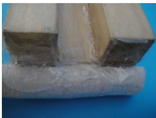
圖六：探討出水口下緣在不同曲率半徑下對茶壺效應的影響(圖為出水口)
