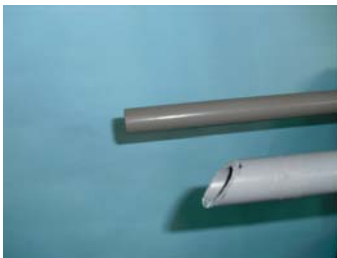
圖四：探討 PVC 硬管在不同出水口切割角度下對茶壺效應的影響
