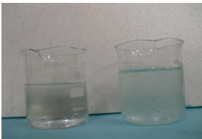
圖三：探討 PVC 硬管在不同黏滯係數下對茶壺效應的影響 (右為海菜膠溶液，左為純水)
