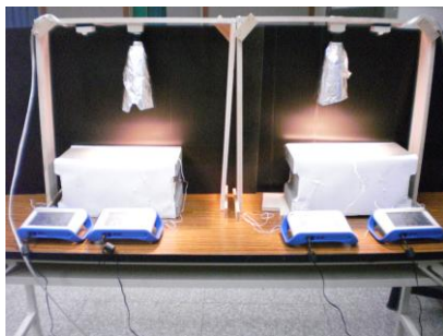
圖 5.3 實驗裝置-輻射加熱
