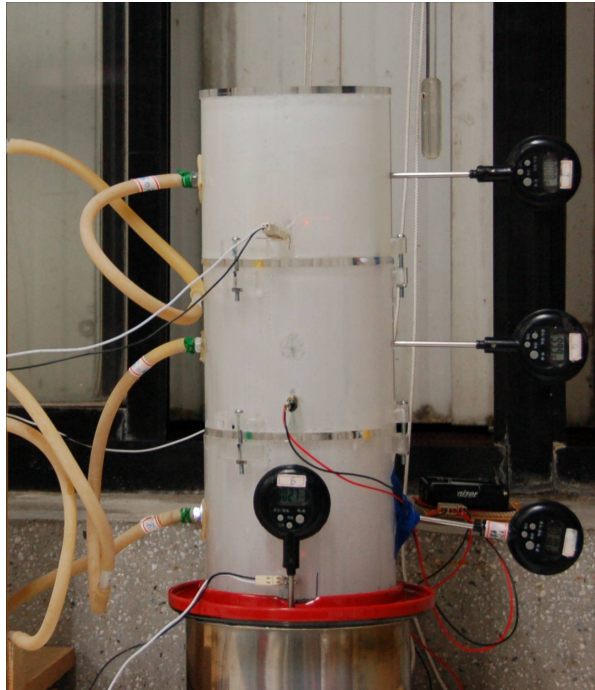
圖 107 抽掉頂端的溫度計，結果，蒸籠第三層的溫度快速上升至 100°C。
