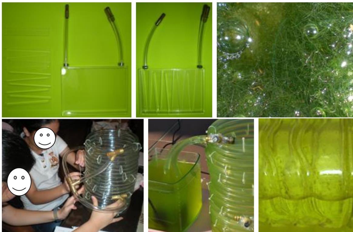
上排：絲狀藻管路槽結構 下排：絲狀藻管路槽組裝與管壁內側藻類附著(持續 2~3 週)
