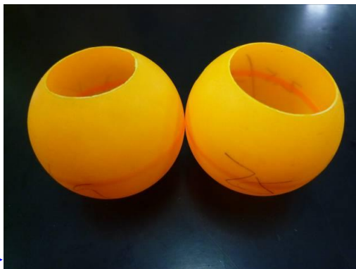
圖 59 陀螺球體切割完成
