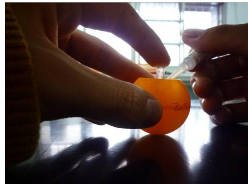
圖 62 在切完球體的底部滴入 3 到 4 滴的三秒膠
