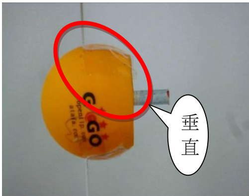
圖 9 轉軸與棉線的夾角趨於垂直
