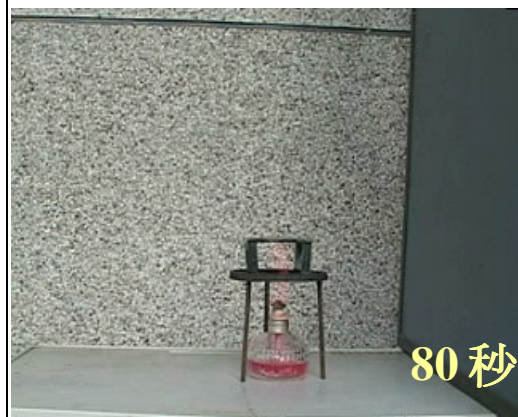
實驗七塗料〈先塗上白膠，乾燥後，再塗上膠水+灰〉與傢俱
