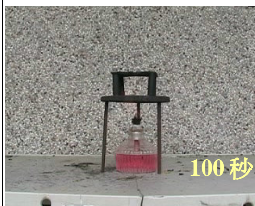
實驗六塗料〈先塗上膠水+灰，乾燥後，再塗上白膠〉與傢俱
