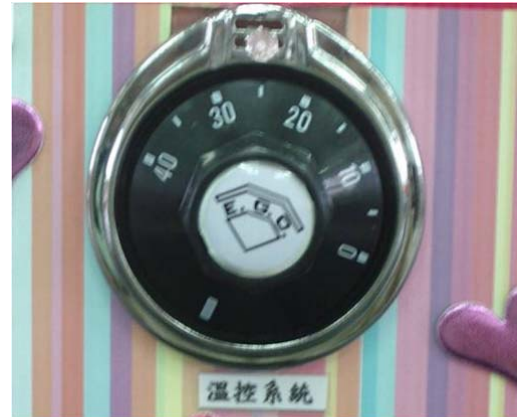
採用機械式溫控器,除了保持系統恆溫外,也可降低成本與延長使用壽命。
