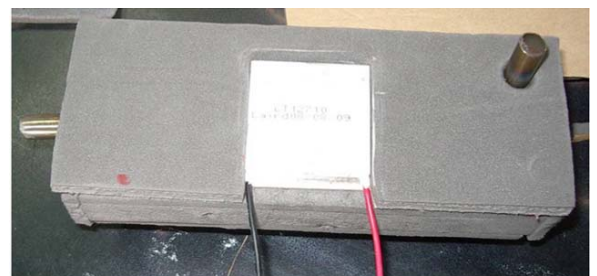
不鏽鋼平台周圍鋪滿泡棉，成功解決冷凝水問題。
