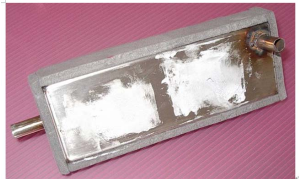
致冷晶片換面時，必須在接觸面塗抹散熱膏，填補接觸面之間的空隙。
