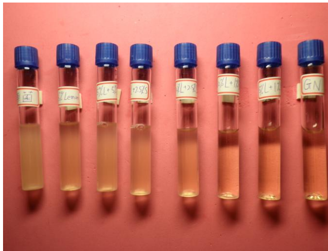
圖四十四、10%檸檬水加1%鹽水和5%檸檬水加1%鹽水培養基和原培養基一樣清澈。
