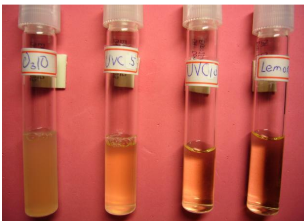
圖二十六、混濁度：臭氧10分鐘 > 紫外線5分鐘 > 紫外線10分鐘 > 檸檬原汁
