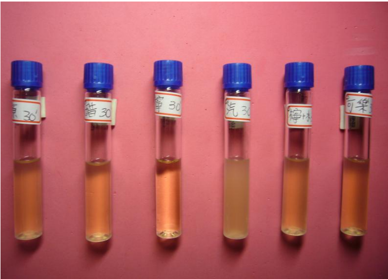
圖三十五、混濁度：汽水>原魚肉>檸檬水、可樂>糯米醋>檸檬原汁
