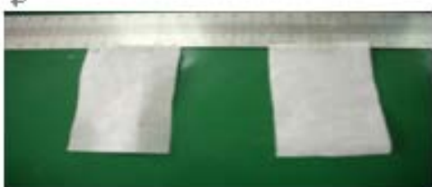
圖 3-2-3 50%、油面處理宣紙放入水中，水被排開，水痕沒有上升。
