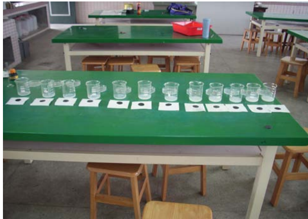
圖 5-2-1 以不同濃度二氧化矽溶液處理後，觀察其字跡的變化
