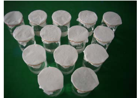
圖 2-1 不同濃度的奈米宣紙透氣性的測量。
