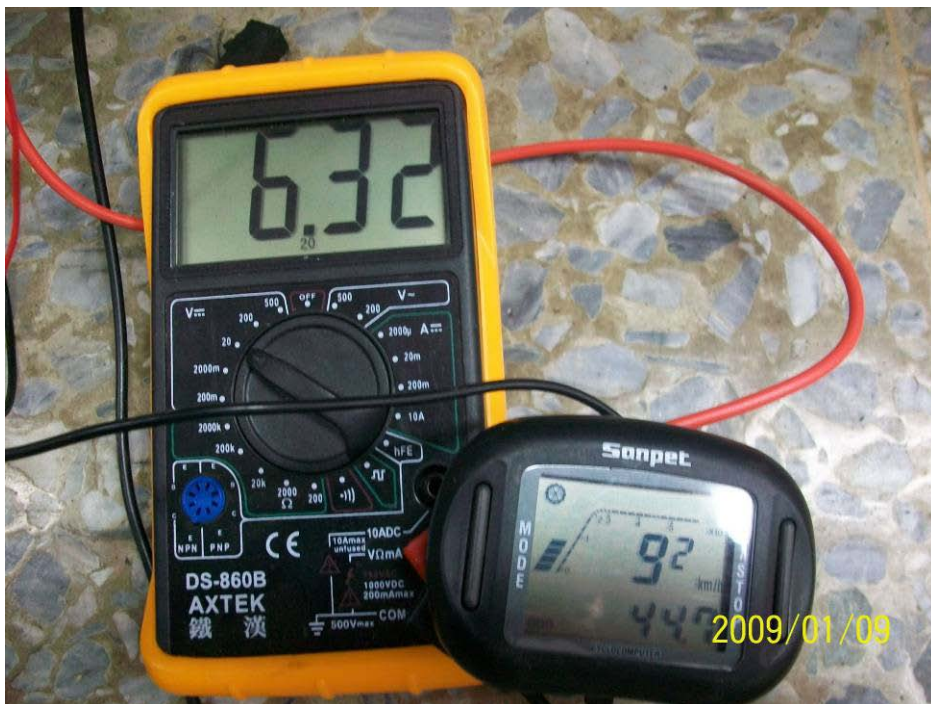
圖 7 測電壓與時速的關係
