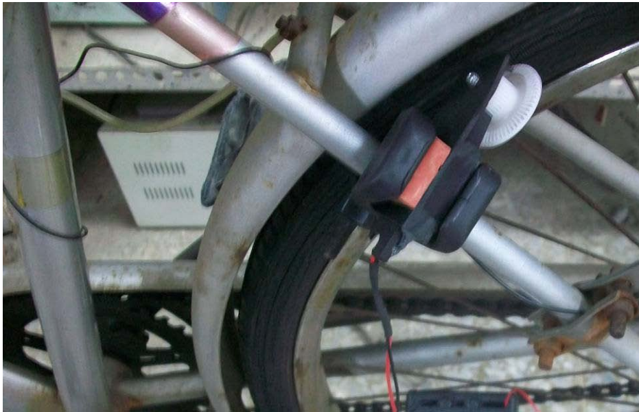
圖 6 將發電機以萬用車燈座安裝至腳踏車上
