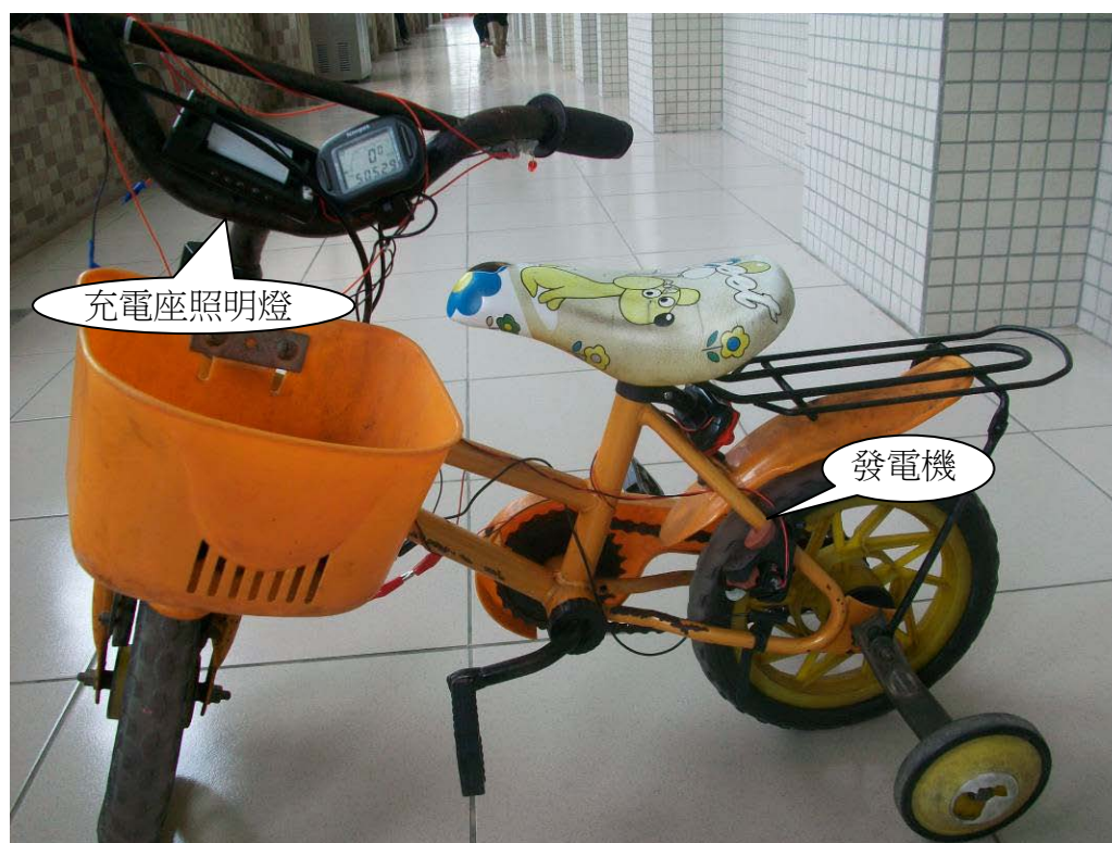
圖 12 腳踏車發電接至充電座
