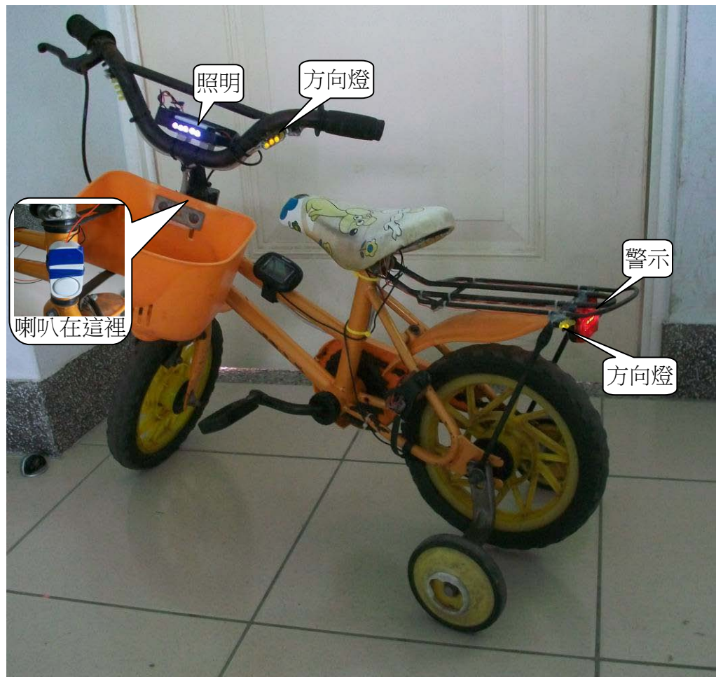
圖 14 照明、警示、方向燈與喇叭都使用同一電源
