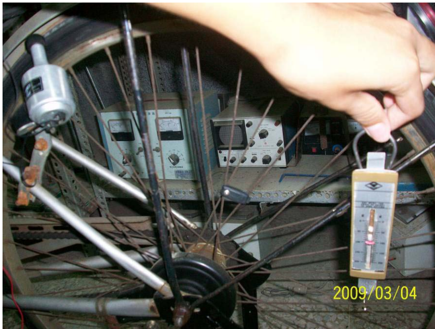
圖 5 測量發電機摩擦力
