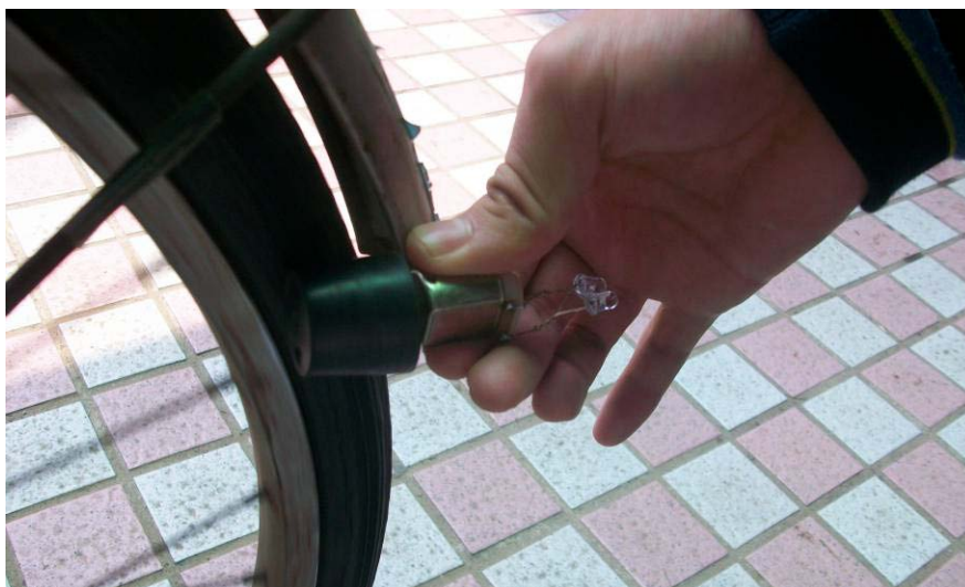
圖 3 發電機直接套上橡皮塞發電測試
