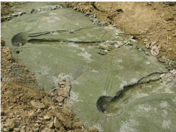
照片 9 新化鎮山腳里五甲勢倒厝溪旁農田土壤液化噴灰綠色砂。
