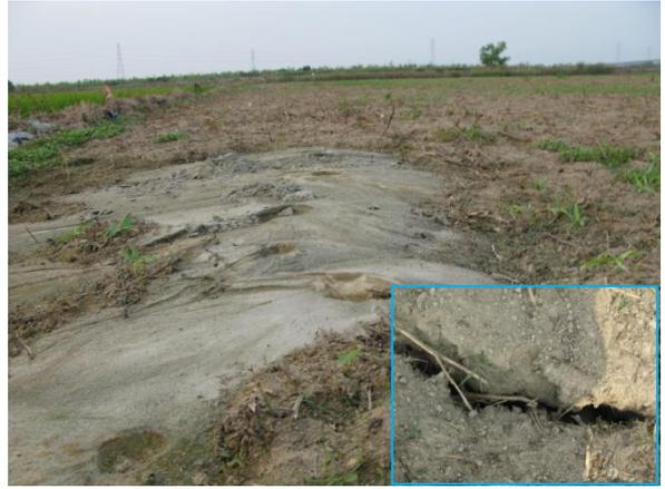
照片 6 新化鎮太平里新永就(烏鬼厝北方)土壤液化噴口與農田裂縫方向一致。
