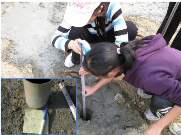
照片 41 北勢噴砂區 SPT 試驗後量測水位。
