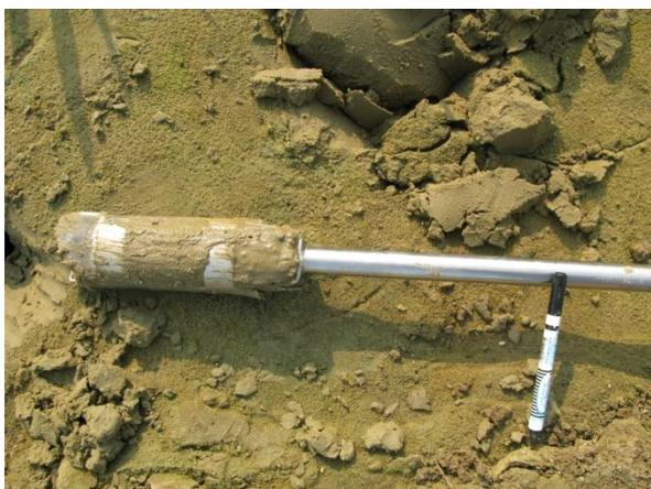
照片 47 離仔尾鳳梨田挖出 0.4m 處的噴砂，已見液化情形。
