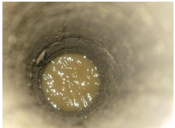
照片 42 SPT 試驗取出的薄管水井可見地下水往西邊流動。
