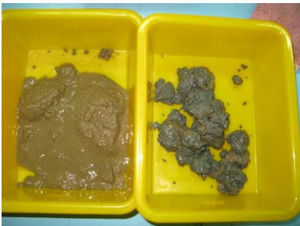
照片 37 離仔尾與倒厝溪的噴砂液化前比較。
