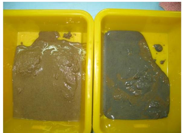
照片 38 離仔尾與倒厝溪的噴砂拍打液化後比較。
