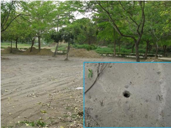
照片 7 虎頭埤後門露營區有小規模土壤液化噴砂。
