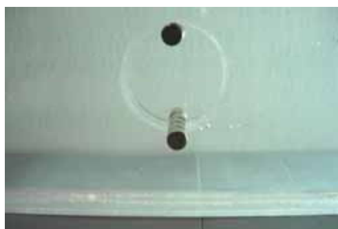
圖 24 以強力磁鐵固定之壓克力圓管
