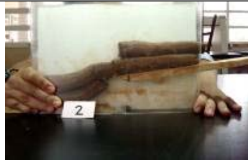
第二次實驗：受力處斷開，坡底變形
