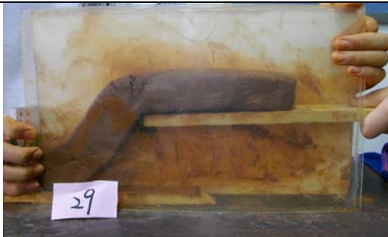
第二十九次實驗：上方出現數個小裂縫
