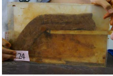
第二十四次實驗：上方裂一大谷狀裂縫
