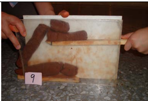
第九次實驗：在受力處斷開
