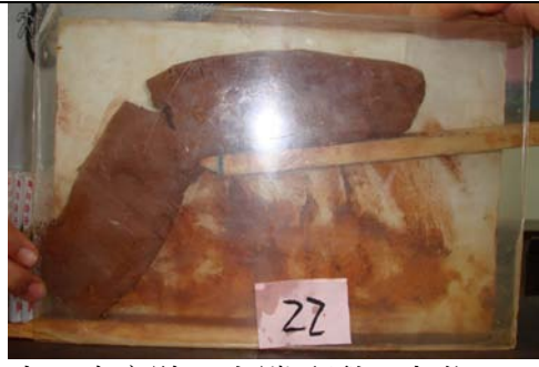
第二十二次實驗：上端分裂一大谷，三小縫
