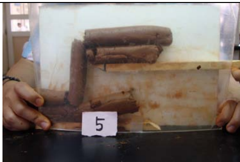
第五次實驗：受力處及底層均斷開
