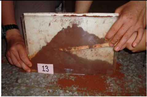
第十三次實驗：崩落後呈平滑坡
