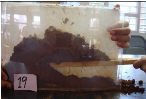
第十九次實驗：前端崖狀，後端谷狀
