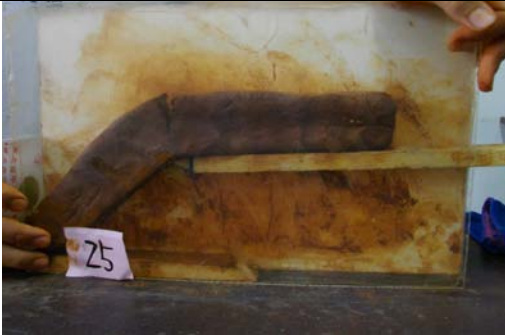
第二十五次實驗：上方裂一大谷狀裂縫
