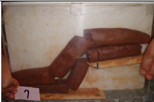
第七次實驗：受力處及底層均斷開
