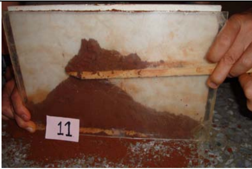
第十一次實驗：大量崩落，上端呈谷狀
