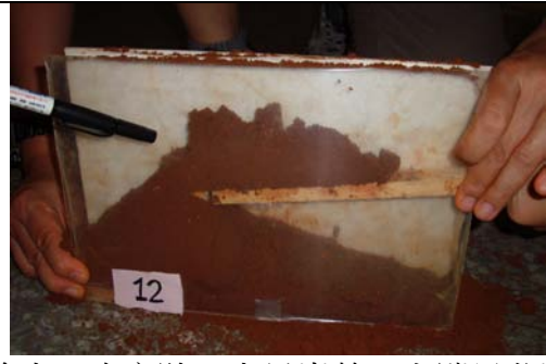
第十二次實驗：大量崩落，上端呈谷狀
