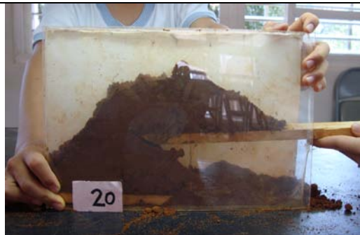
第二十次實驗：呈凹陷坡
