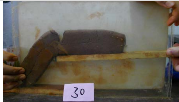
第三十次實驗：上端後方有一大裂縫
