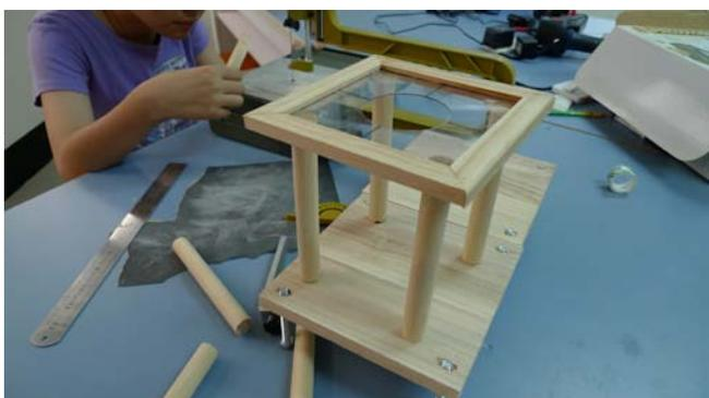
圖 4-7、可調整水平之木架平台
