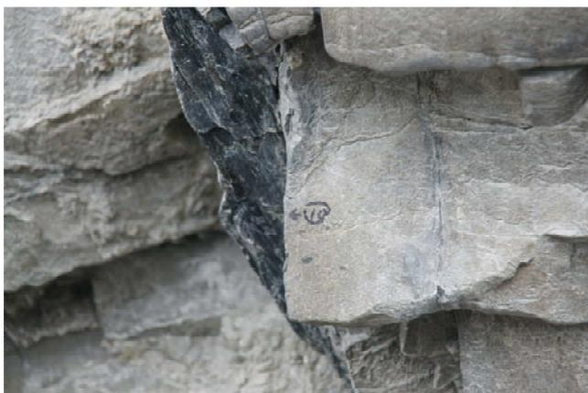
圖四十九編號 10：夾層中的斷層泥
