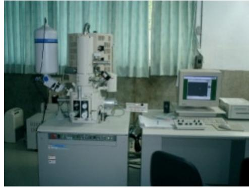
圖三 高倍率掃描電子顯微鏡 SEM
