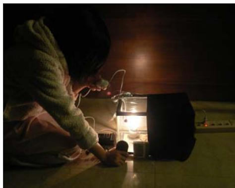
圖5-3 利用電流微調裝置及電子式溼溫度計、數位式照度計準確控制箱內溫度及亮度
