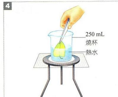
待葉片顏色褪去變淡，熄滅酒精燈，把小燒杯由大燒杯取出，再以鑷子將葉片夾出，改放入大燒杯內的熱水漂洗。
