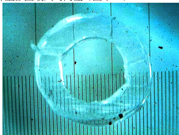
B 段塑膠圈：最大內徑（共 16 格，每格 0.1mm）=1.6 mm。
