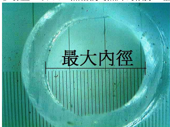
A 段塑膠圈：最大內徑（共 28 格，每格 0.1mm）=2.8mm。
