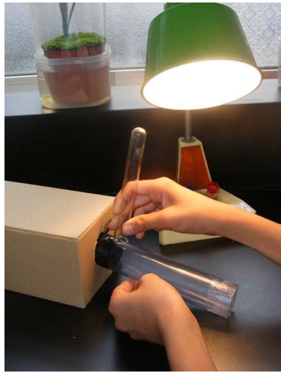
圖五．測驗成蟲對光線刺激反應的實驗箱，由兩個部分組成：塑膠管（左圖）和暗箱（右圖）。塑膠管是由長約 30 公分的透明塑膠管組成，其中一半貼上黑色不透明膠帶，另一半則保持透明；在塑膠管中間處鑽一個成蟲可通過的小孔。暗箱是由不透明的紙盒組成，一端鑽一孔恰可容納塑膠管。
