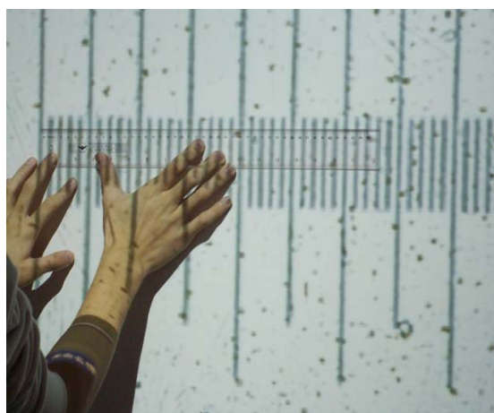
圖十六、用直尺測量電子白板的測微器刻度
