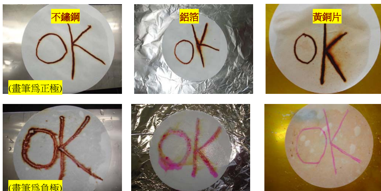
圖(十) 不同導電板對正、負極顏色呈現的影響
