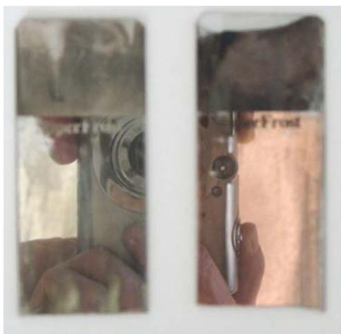
圖二十一 以載玻片製作銀鏡(左)與銅鏡(右)。
