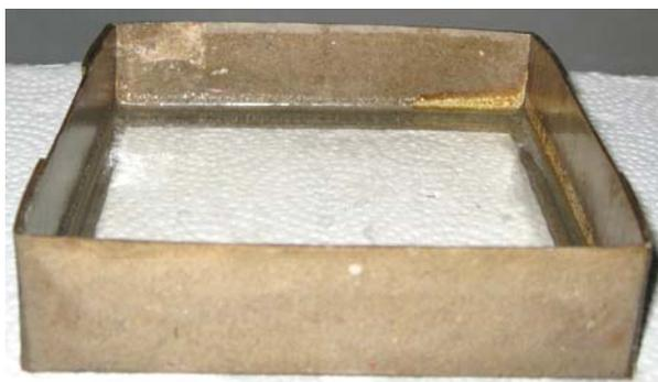
圖三 以透明環氧樹脂和厚紙板製作的反應容器。
