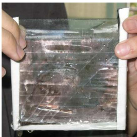
圖十六 二玻片以橡膠封邊試作銅鏡的結果。
