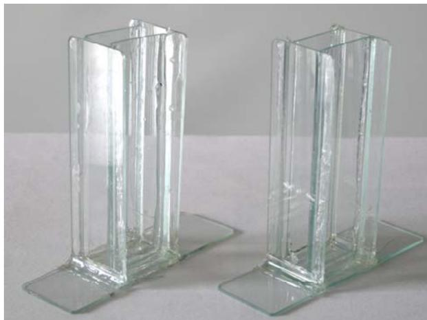
圖四 以載玻片製作的反應容器。
