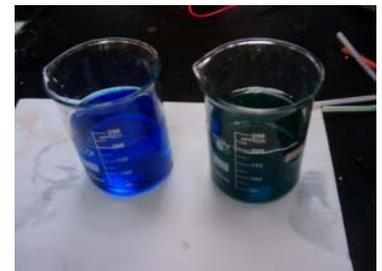
實驗七：右圖為不同時間外槽液體與硫酸亞鐵之反應情況；到三分鐘時顏色有較明顯之改變，因此推論三分鐘後，蛋殼內的溶液已流出蛋殼外，將影響實驗結果。(如圖十四)
