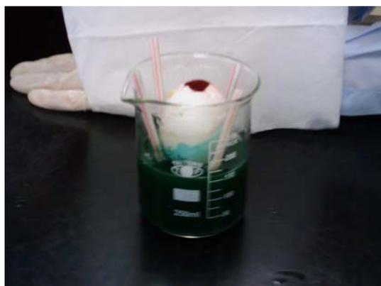
圖七：亞甲基藍+酵母菌+葡萄糖(外槽)及赤血鹽(內槽)
