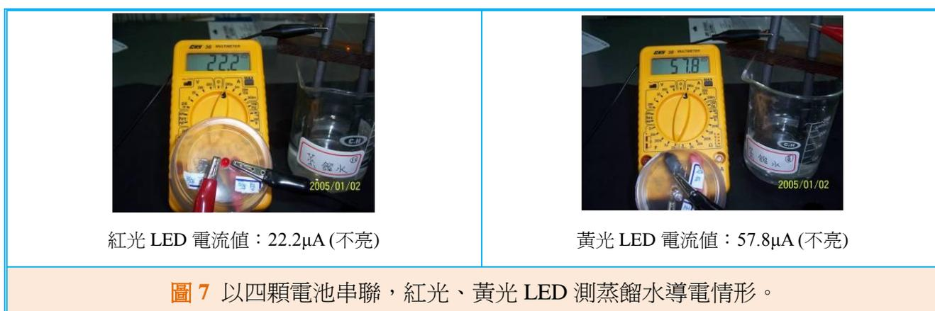
2、使用三顆電池串聯(電壓約 4.7V)，以紅光、黃光 LED 的亮度檢驗 100mL 的待測液(蒸餾水、葡萄汁、蘋果汁、礦泉水、自來水、運動飲料等)的導電情形，除蒸餾水呈「不亮」外，其它待測液呈「明亮」或「很亮」狀態。可明顯的區分出蒸餾水為非電解質；葡萄汁、蘋果汁、礦泉水、運動飲料、自來水等為電解質，如下圖所示。
