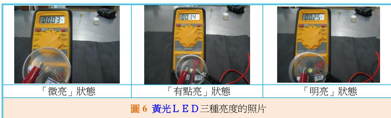
二、用 LED 的亮度檢驗蒸餾水、葡萄汁、蘋果汁、礦泉水、運動飲料、自來水的導電情形。
