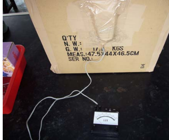
圖三 照度計貼在箱子上
