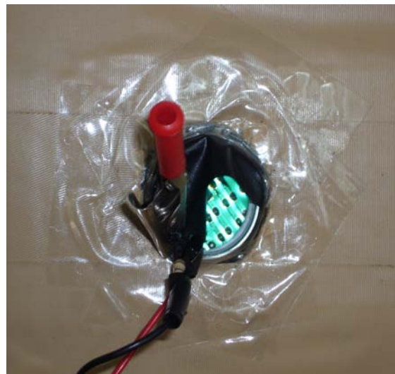
圖五 手電筒改裝底接變壓器
